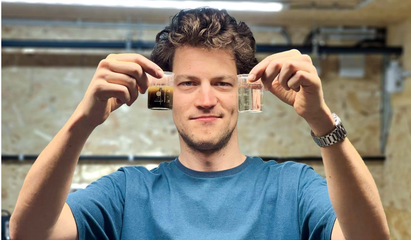
Aymar de Lichtervelde untersucht zwei Wasserproben: links das am Eingang des Systems eingeleitete Abwasser (hier Schwarzwasser), rechts das gereinigte Wasser, das wiederverwendet oder an die Umwelt zurückgegeben werden kann.
